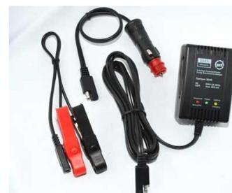
**BA 200** : Chargeur de batterie automatique 6V/12 V sous courant de Charge 2 A, tension maxi 14,3 V pour toutes batteries ; 7 LEDS de Contrôle avec micro processeur, détection automatique de défaut et Affichage type de maintenance . Livré avec pinces crocodile entièrement Isolées, fiche allume cigare, DIN BMW et multi connection ; jeu de Câbles pour batterie PVTC = 140. -
